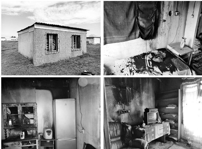
Рис. 1. Смоделированные на площадке № 1 очаги пожара
